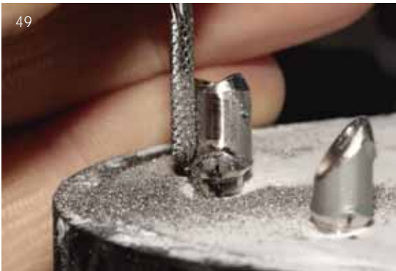
Abb. 49 Die Friktionsfläche wird mit einer kreuzverzahnten Fräse und Fräsöl bearbeitet. Der Hochglanz wird mit einer Feinfräse und Fräsöl eingestellt
