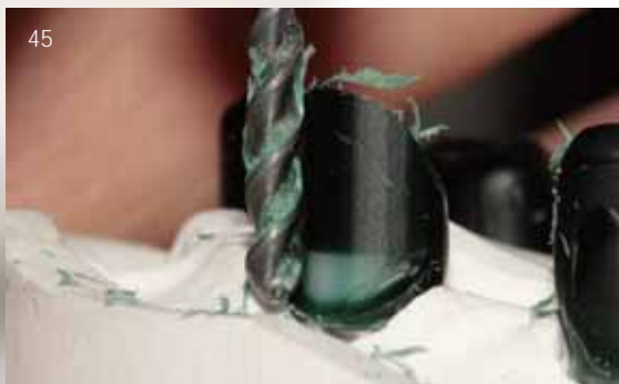
Abb. 45 Die Primärteile werden der gemeinsamen Einschubrichtung entsprechend mit einer Wachsfräse gefräst
