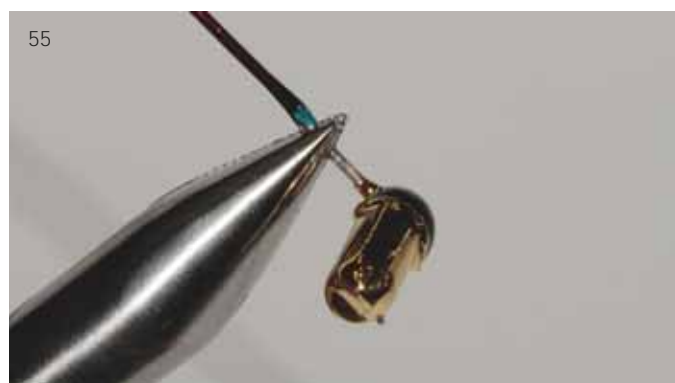
Abb. 54 und 55 Das Feingold wird mit einer Schichtstärke von 200 µm aufgetragen. Die Kupferelektroden können mit einer Zange entfernt werden
