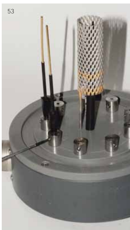
Abb. 53 Die Kupferelektroden werden samt den daran befestigten Primärteleskopen am Kopf des Galvanogeräts befestigt
