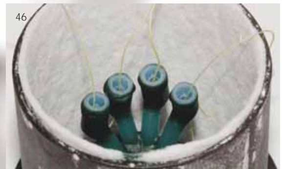
Abb. 46 Um beim Einbetten Bläschen in den Schraubenkanälen zu vermeiden, werden Nähfäden eingebracht. Beim Herausziehen wird EBM in den Schraubenkanal gezogen
