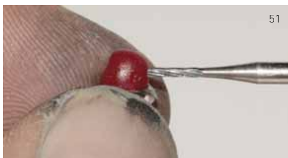
Abb. 51 In den Modellierkunststoff wird ein Loch gebohrt, in dem die Kupferelektrode mit Sekundenkleber befestigt wird
